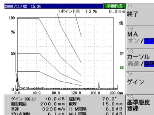
図8 250mmでのDAC作成結果
