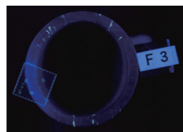
写真2 蛍光浸透探傷のキズ指示模様
